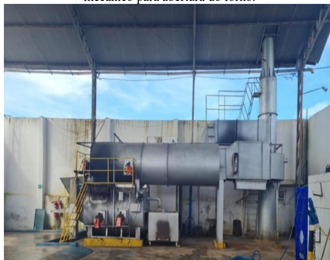
Figura 57 – Vista da plataforma de carga e do dispositivo mecânico para abertura do forno.
