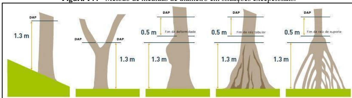
Figura 144 - Método de medidas de diâmetro em situações excepcionais.
