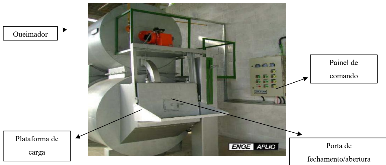
Figura 60 – Ilustração do equipamento semelhante utilizado na Cril, com componentes do forno de incineração, painel de comando, queimador, plataforma de carga e porta de fechamento/abertura.
