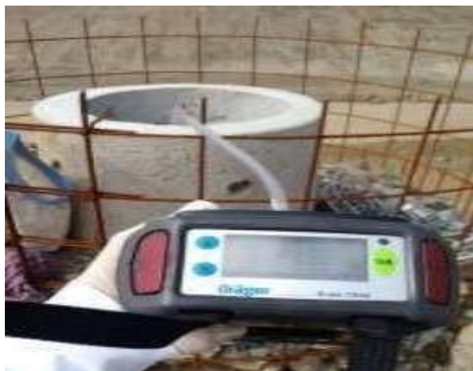
Figura 363 – Monitoramento das concentrações de biogás em drenos verticais de Aterro Sanitário com o Drager modelo X-AM 7000.
